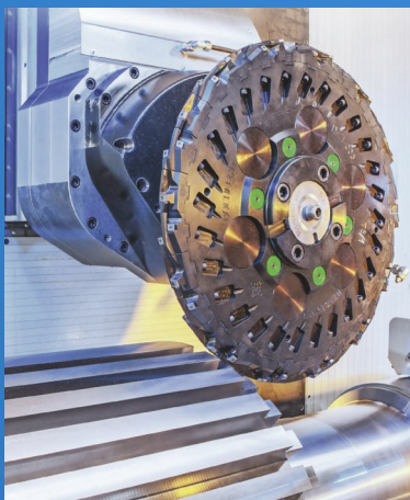
Sondergetriebekopf mit Scheibenfräser von der Firma WEINGÄRTNER MASCHINENBAU.
